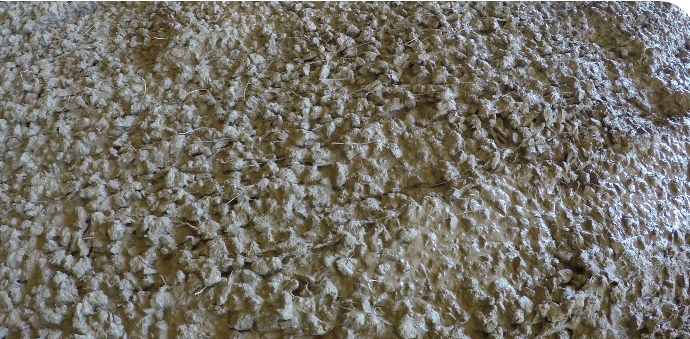
A adição de fibras de aço ao concreto, transforma o material em um compósito, apresentando desempenho superior. Existem quatro características que são aprimoradas com a técnica:
